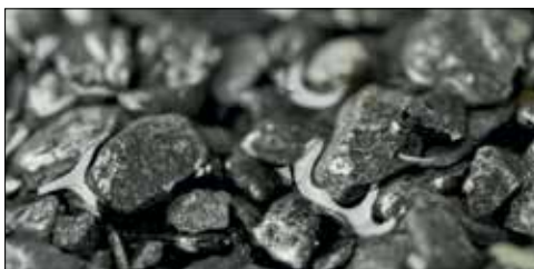
Zwykła, nasiąkliwa posypka. Wilgoć wnika w strukturę posypki oraz pomiędzy poszczególne ziarna.
