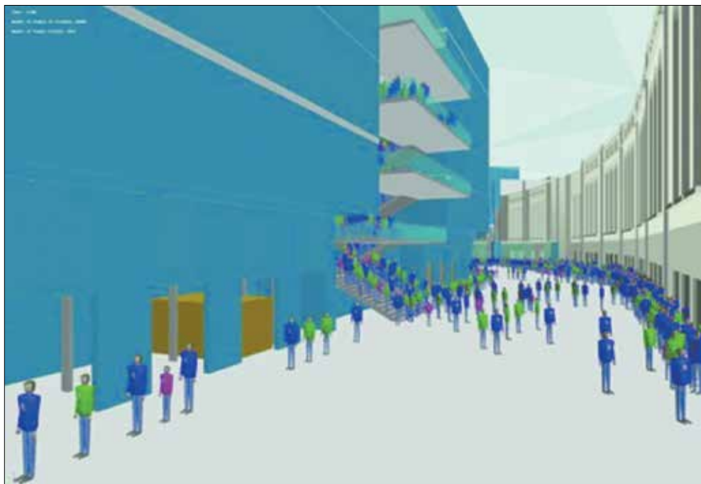
Rys. 5. Zastosowanie BIM 8D do modelowania drogi ewakuacyjnej [11]
