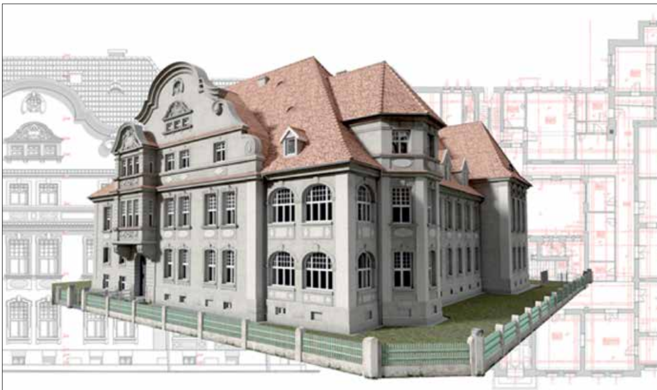
Rys. 2. Przykład inwentaryzacji z wykorzystaniem technologii chmury punktów – Model BIM – Sąd Rejonowy w Katowicach (rys.: www.bimpoint.pl )
