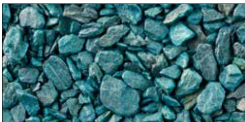
Ceramiczna posypka Flagowych Pap Icopal o charakterystycznym niebieskim kolorze i strukturze spiekanej w wysokiej temperaturze.
