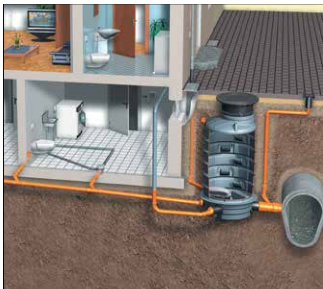
Rys. 1. Prawidłowo zainstalowana ochrona przeciwwzalewowa z zewnątrz budynku: przybory zlokalizowane poniżej poziomu zalewania są zabezpieczone zaworem zwrotnym w studzienice. Przybory zlokalizowane powyżej poziomu zalewania oraz odpływy z rynien włączone do studzienki za urządzeniem przeciwwzalewowym.
