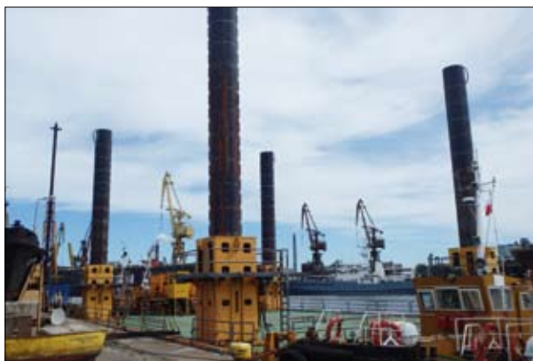
Samopodnosząca się platforma, tzw. hydroszczudlak
