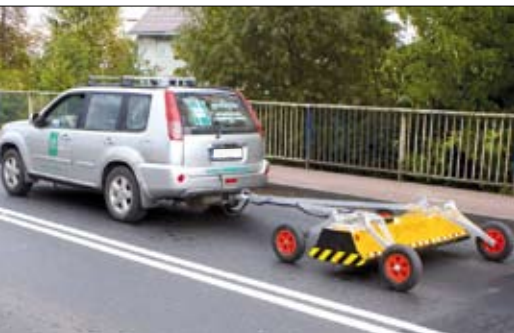
▲ Fot. 1. Georadar 3D RADAR
