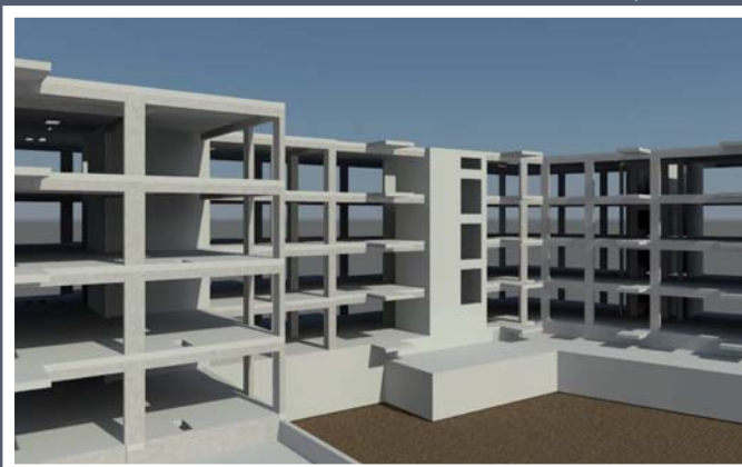
Osiedle mieszkaniowe. Projekty konstrukcji wykonane w Revit Structure, Chodor-Projekt
